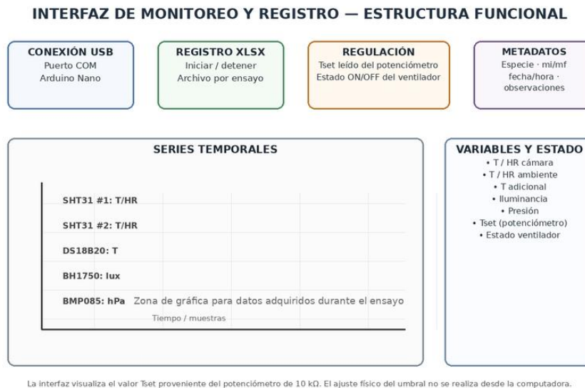
Figura 3. Estructura funcional de la interfaz de monitoreo y registro; la consigna Tset se ajusta físicamente mediante el potenciómetro y se visualiza junto con el estado del ventilador.
