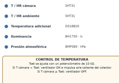
Figura 4. Variables registradas y lógica de regulación térmica basada en la consigna Tset ajustada mediante potenciómetro.
